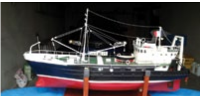
LE LUTECE : Chalutier Congélateur à relevage par l'arrière. 2 cales à poissons : de 40 et 91 M3 à - 25°
